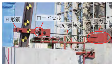
写真-2 T-PS7 試験体の荷状況
