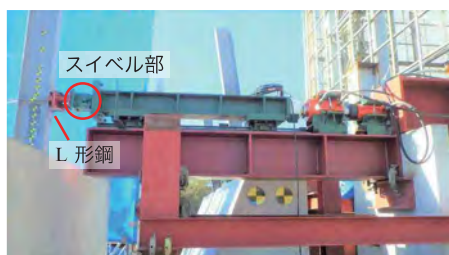
写真-1 C-PS7 試験体の荷状況
