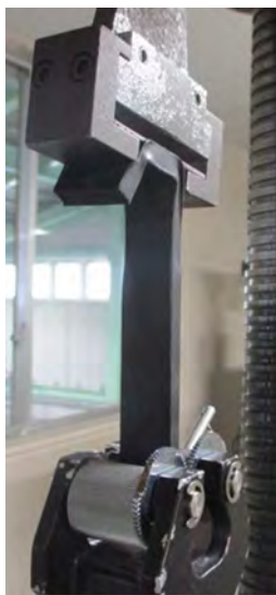
写真-1 90°剥離試験状況
