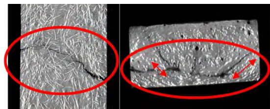
図6 ひび割れ発生箇所の例
