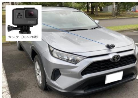
図-1 簡易カメラ搭載型舗装点検システム
