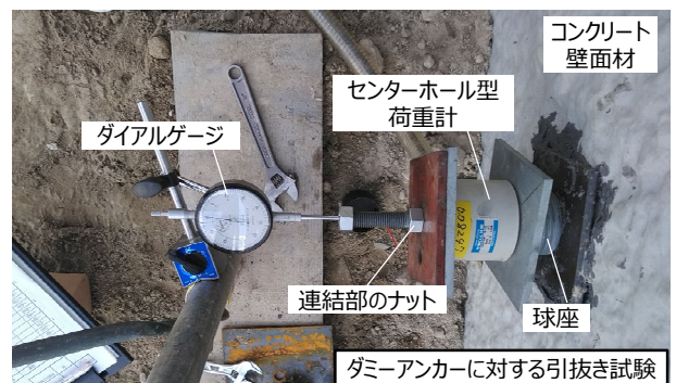
図-5 竣工後の計測方法に関する概略図
