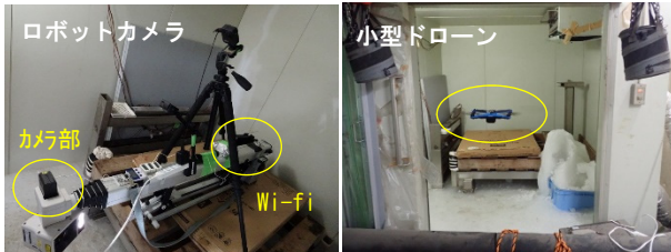
図-1 耐寒試験実施状況
