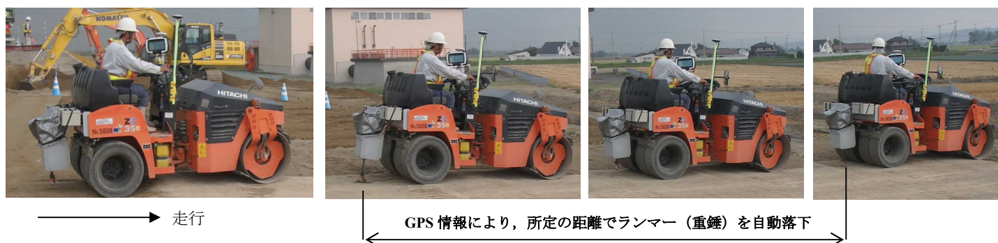
図-3 衝撃加速度法の自動化
