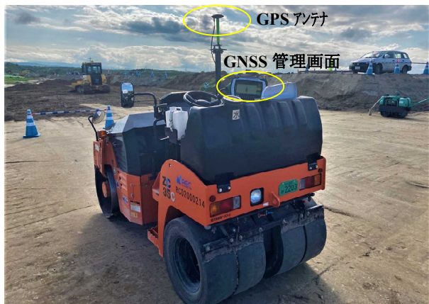
図-1 GNSS 管理を装備したローラー
