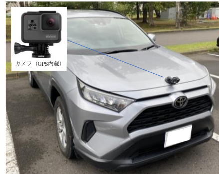
図-1 簡易カメラ搭載型舗装点検システム
