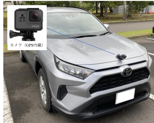
図-1 簡易カメラ搭載型舗装点検システム
