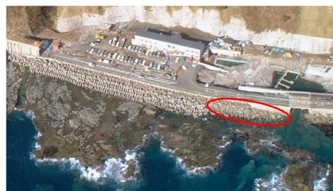
写真-3 道の駅前面の消波ブロック被災状況
