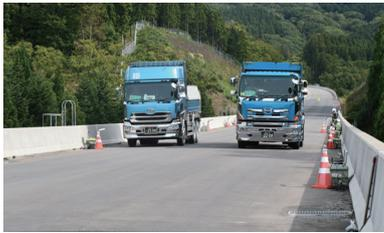
写真-2 大型車両による加振状況
