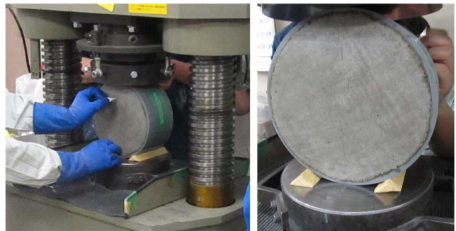
写真-1 ひび割れ導入時の状況（中央に割裂ひび割れ）
