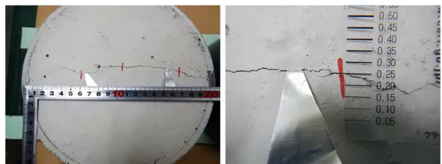
写真-3 暴露開始前のひび割れ幅測定状況
