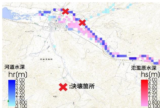
図 8 ピーク時 (2016 年 8 月 31 日 1 時) の河道水深と氾濫原水深の計算結果
