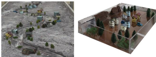
写真-6 侵食実験後の様子 写真-7 破堤実験後の様子
