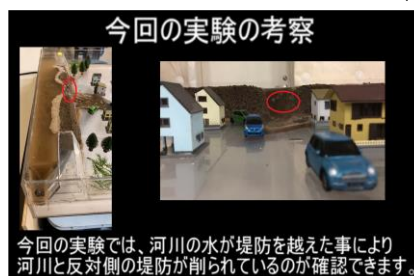
写真-9 実験動画に解説、避難方法等を付け加えて編集した動画(侵食実験, 破堤実験, 斜面災害実験)
