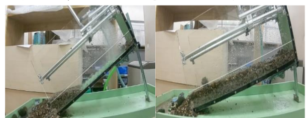
写真-8 斜面災害再現の実験後の様子 (がけ崩れ(左), 地すべり(右))
