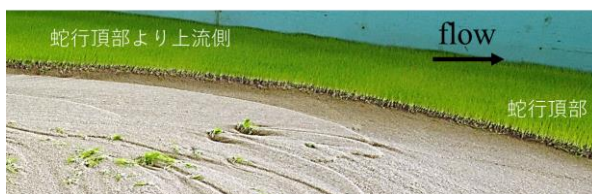
図-7 Case2 における水衝部河床洗掘の様子（通水開始 150 分時点）
