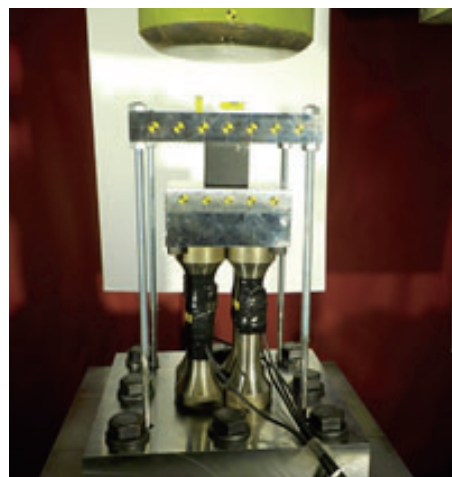
(a) 90 kN 級ロードセルを設置した場合
