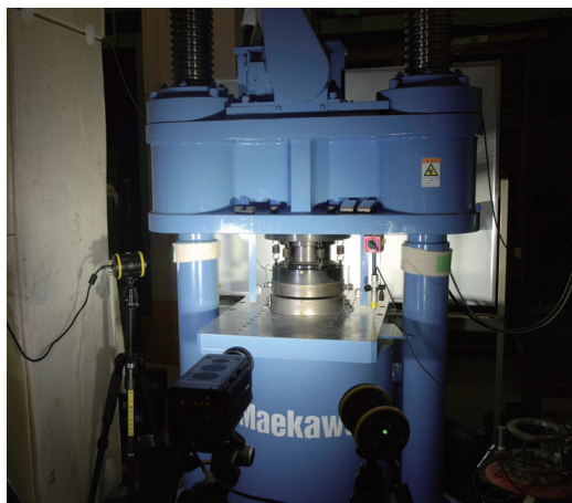
写真－1 静荷重載荷実験の状況
