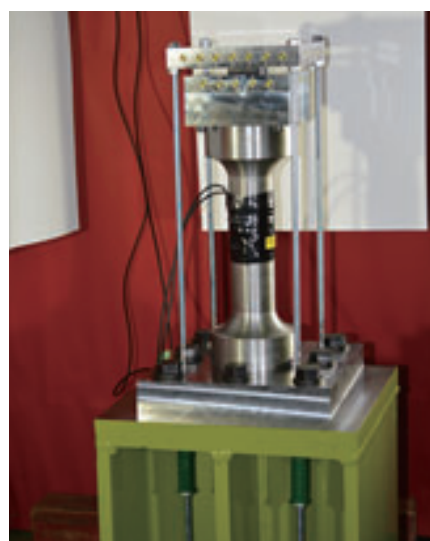
(b) 490 kN 級ロードセルを設置した場合
