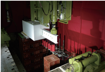
(b) 重錘落下衝撃荷重実験
