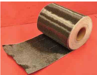
写真-1 CFRP シート
