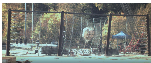
写真-1 検証実験における最大重錘貫入時の変形状況
