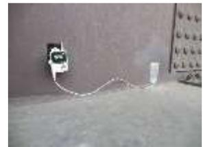
(a) 3 軸加速度計(JA-70SA) (b) 温度計(RTR-502)
