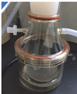
図-5 実験開始前のシートの浸漬装置
