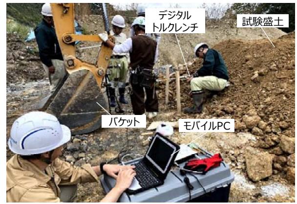
写真-2 屋外に構築した試験盛土を用いた試験の様子
