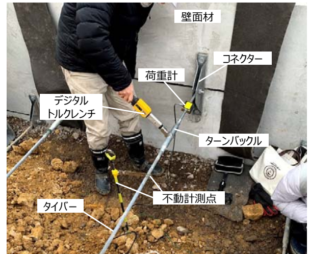
写真-2 屋外に構築した試験盛土を用いた試験の様子
