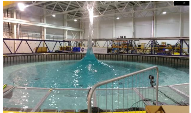
図一1 FloWave による鉛直ジェットの生成
