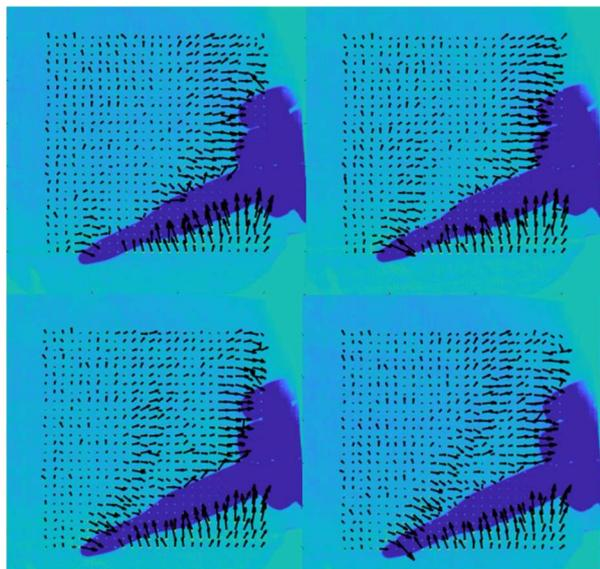
図5 400℃近くまで熱されたハンドウォーマー近傍の屈折率変化の可視化画像
