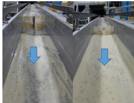
図-7 堆積後とスリット化後の砂防ダム模型写真
