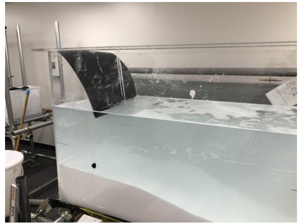
図4 給水の際に水の勢いを弱めるための板
