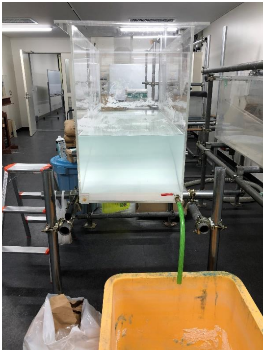
図2 水槽下流面に設置されたバルブ
