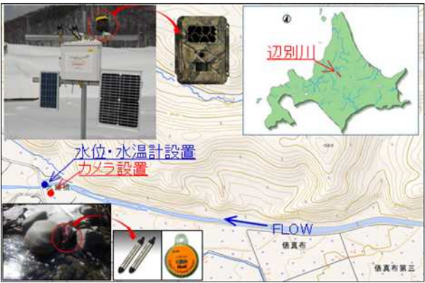
図-1 現地観測場所および観測機材
