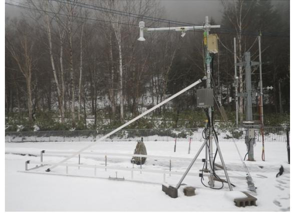
図-8 誘電式含水率計の写真。白いロープが計測機となっている。
