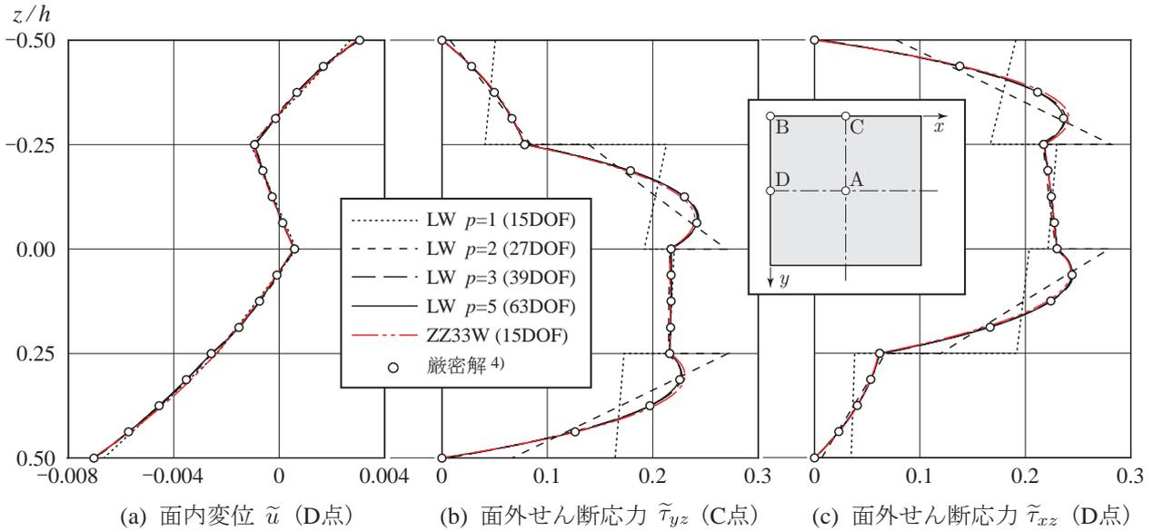
図-5 逆対称4層積層板 [0/90°/0/90°] の変位と面外せん断応力の分布
