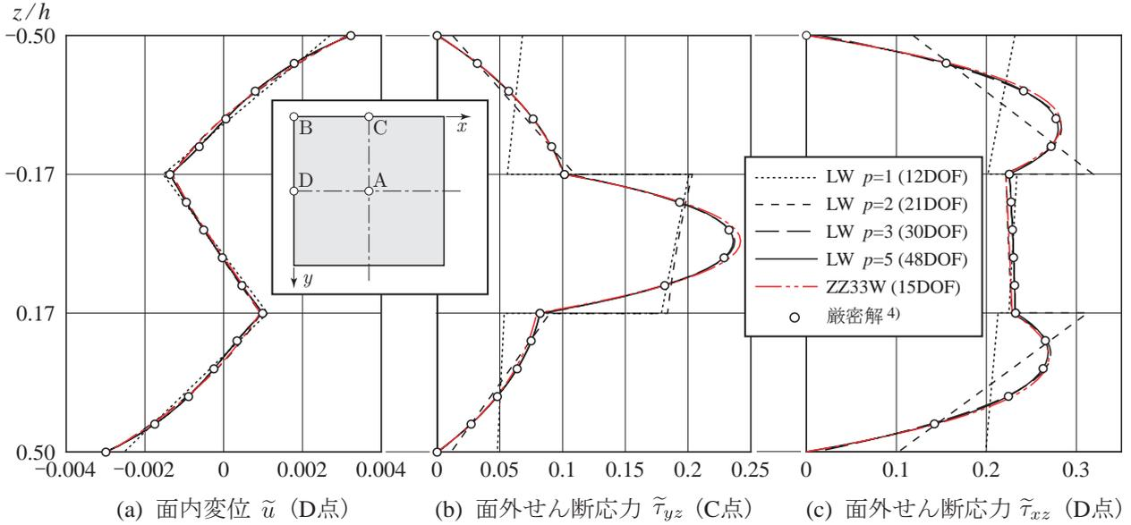
図-4 対称3層積層板 [0/90°/0] の変位と面外せん断応力の分布
