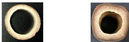
(a) モウソウチク断面 (b) シホウチク断面
