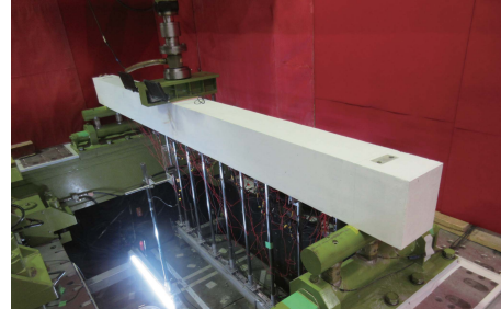
写真－２ 静的荷重載荷実験装置と試験体の設置状況
