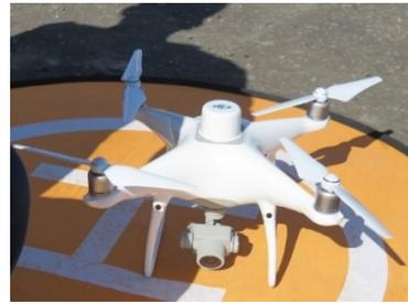
図2 DJI社製、Phantom4 RTK
