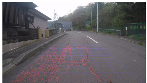
図-5 CNNによるひび割れ検出結果 (一例)
