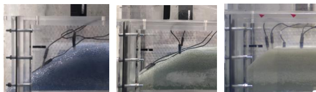
図-2: 融解終了後の斜面崩壊の様子
