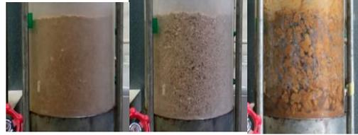
写真-1 透水試験中の様子：(左から)美瑛火山灰質土、柏原火山灰質土、当幌火山灰質土
