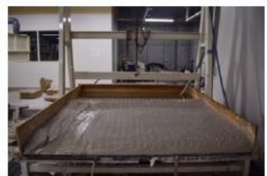
図一11 実験2 チャネルが1本に収束した様子 2回目（以下実験2と記す）は実験1と同じ地形に植生模型を5cm間隔に挿して水を流した。（下図一5）
