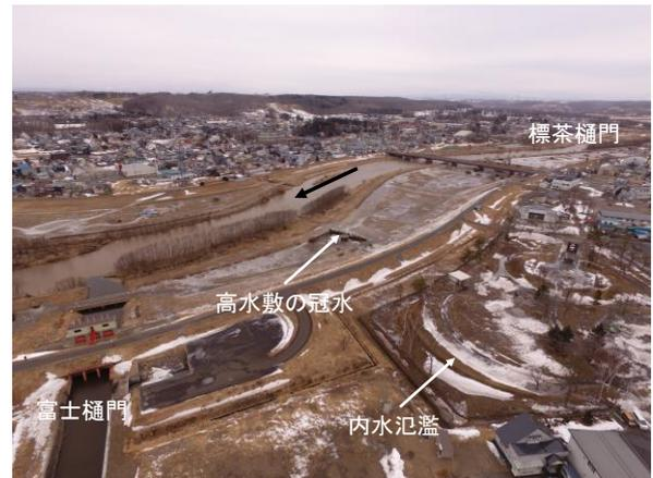
図-1 釧路川標茶・弟子屈における ROS に伴う融雪出水の様子、高水敷の冠水と内水氾濫が確認される (2018年3月9日撮影、(株)北開水工提供)
