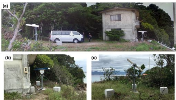
図1 船舶レーダの設置状況。(a)設置場所の全様、(b)水平船舶レーダ、(c)鉛直船舶レーダ
