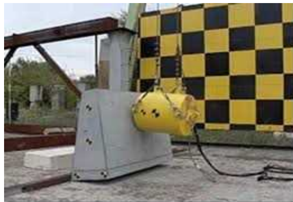
図-3 落石防護擁壁性能試験
