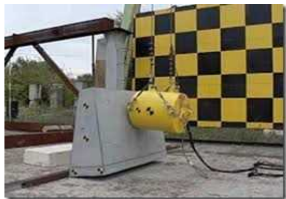
図-3 落石防護擁壁性能試験
