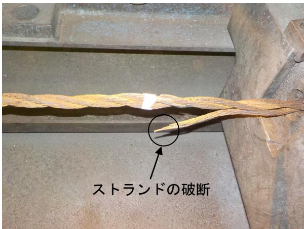
写真-8 試験後の状況（ガードケーブル 2-4）
