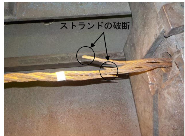
写真-9 試験後の状況（ガードケーブル 2-5）
