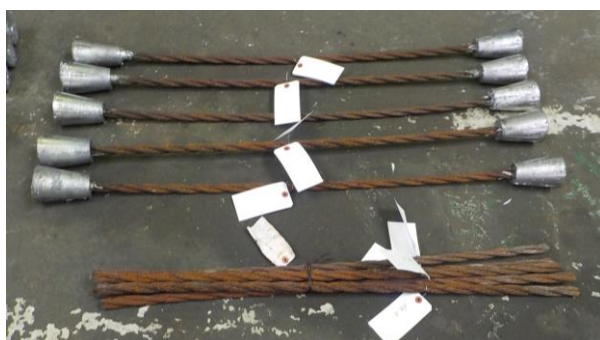
写真-3 試験体外観（ガードケーブル）
