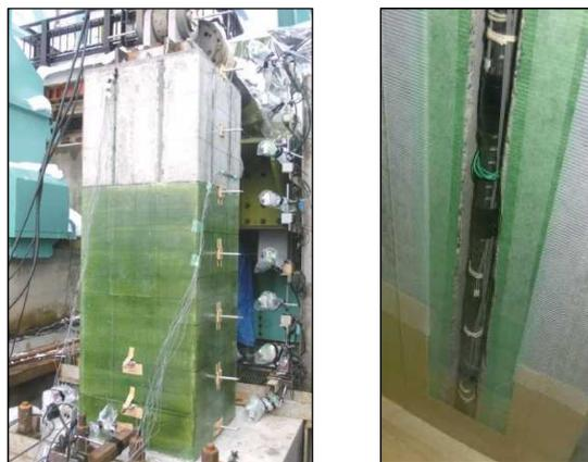
写真-1 正負交番載荷試験状況およびコンクリートかぶり部に埋込定着した耐震補強用軸方向鉄筋（樹脂充填前）
