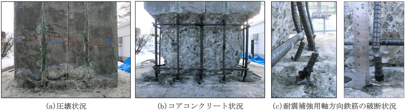
写真-2 柱基部コンクリートおよび耐震補強用軸方向鉄筋の破断状況（補強試験体-B面）
