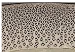
図-1(a) 竹断面の維管束分布
