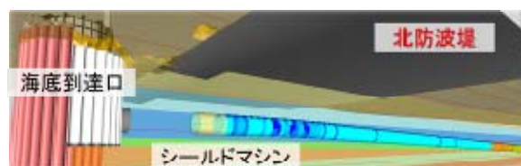
図-2 北防波堤直下通過時の CIM 画面
