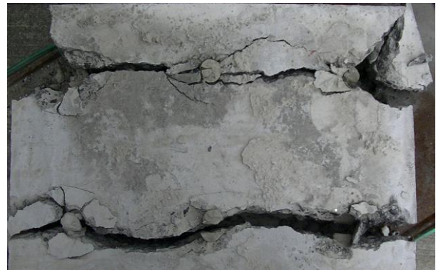
写真-2 市販の静的破砕剤での供試体破壊試験
