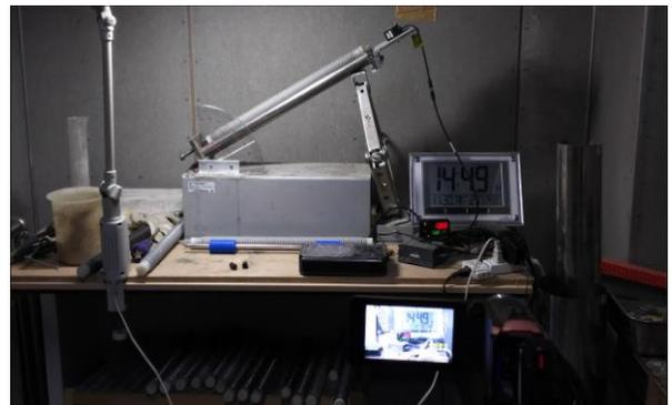
写真-1 長さ変化試験機と測定の様子
