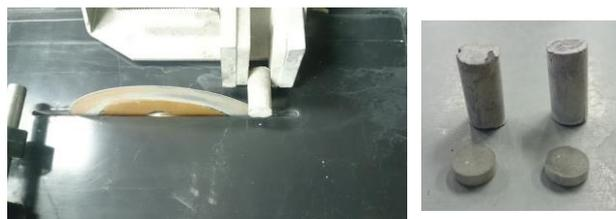
図-2 試験体製作の様子
