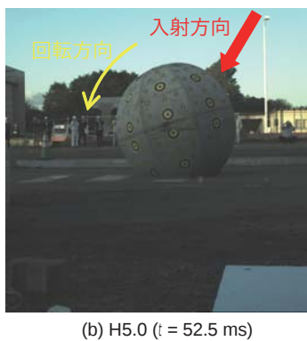
写真-2 落体最大貫入時の高速カメラ画像
