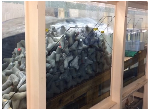
写真-3 消波工による砕波の状況
