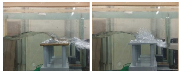
写真-2 床板への波の作用状況
