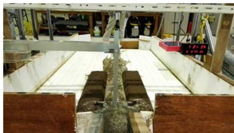
写真-4 土石流流下状況 (ケース 1, 通水 10 秒後)
