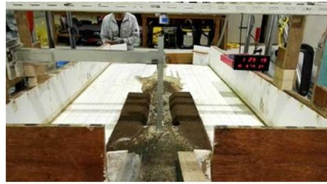
写真-6 土石流流下状況（ケース 3，通水 8 秒後）
